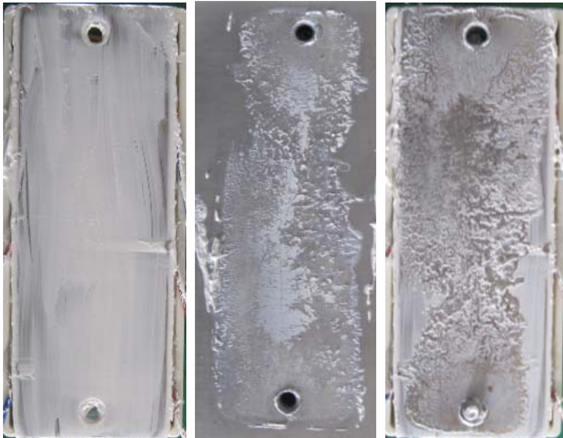
模块底板 (安装前) 散热器底面 (安装后) 模块底板 (安装后)
