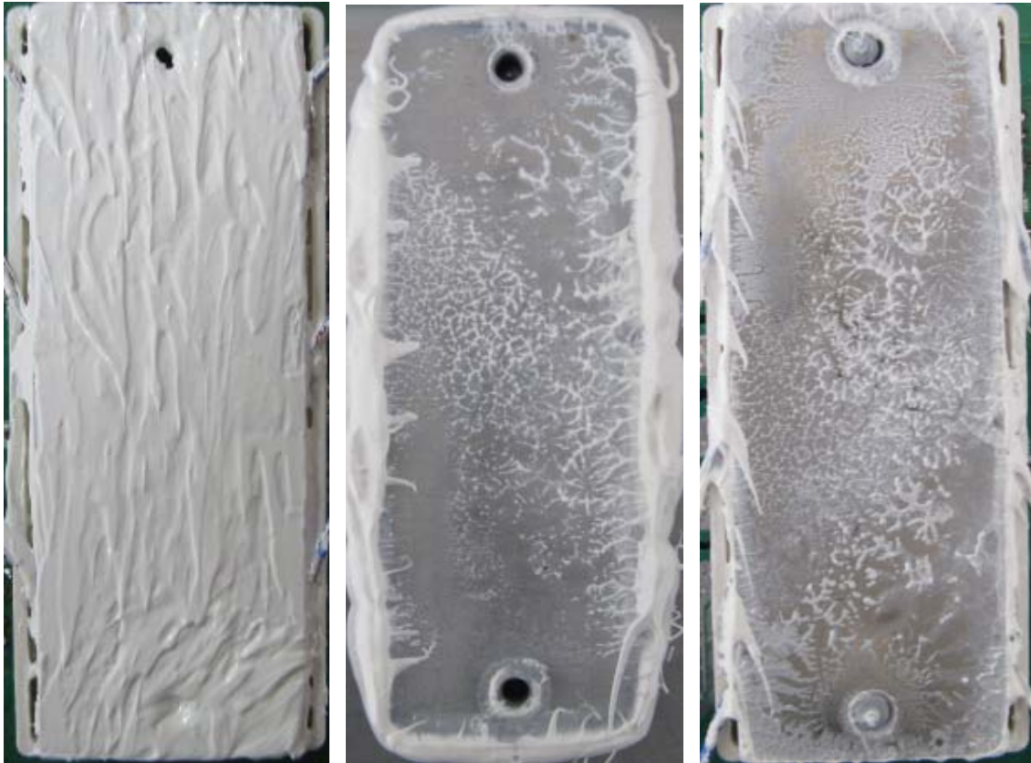
模块底板（安装前） 散热器底面（安装后） 模块底板（安装后）
